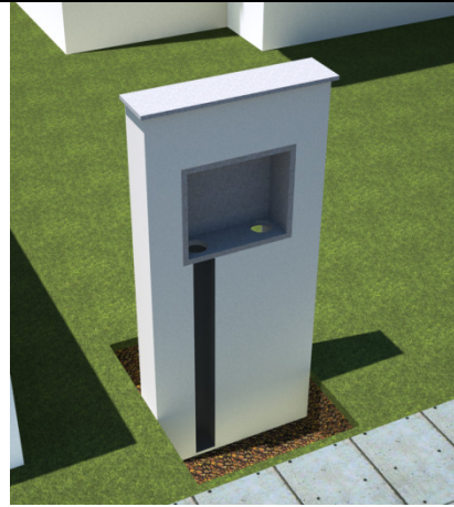
PASSO 2 – POSICIONE A CAIXA NIVELADO COM A FACHADA
