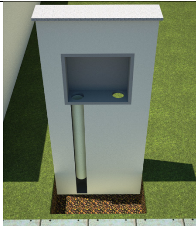
PASSO 3 – POSICIONE O TUBO CAMISA, DEVE SER CHUMBADO NA PAREDE
