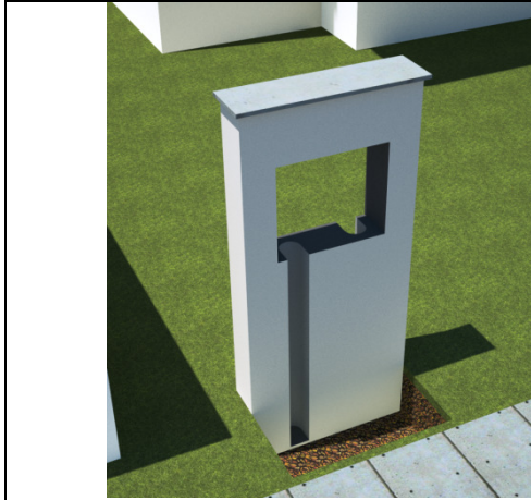
PASSO 1 – PREPARAR O MURO PARA INSTALAR A CAIXA E TUBOS
